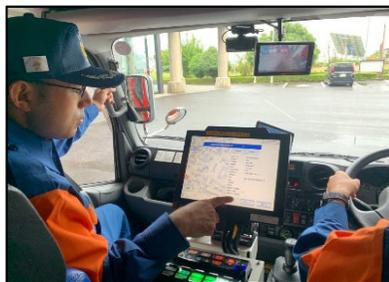
車両動態表示装置の導入
