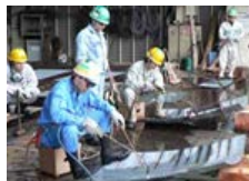
ぎょう鉄（鉄板曲げ加工）
